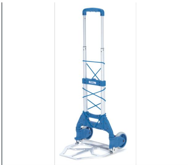
Fabrication de grande qualité en tube d'aluminium avec bavette en aluminium et parties en plastique de première qualité. Poignée de sécurité en plastique agréable au toucher. Sandow pour sécuriser les charges. Mise en place des roues et bavettes en quelques secondes. Roues à bandage polymère bleu gris "non traçant", moyeu à roulement à rouleaux.
