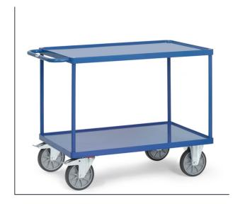
Système modulable : ensemble mécano-soudé, revêtement époxy RAL 5007, assemblé selon le principe des "inserts fetra". Plateau en tôle d'acier soudé avec rebord de 10 mm de haut. 2 roues pivotantes et 2 fixes à bandage TPE, moyeu à roulement à billes central. Roues gonflables 220 x 70 mm en supplément. Freins sur roues pivotantes conformément à la Norme Européenne EN 1757-3 (Sécurité des chariots de manutention). Charge maximum plateau du haut : 200 kg.
