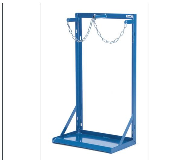
Construction en profilé et tôle d'acier, revêtement époxy bleu RAL 5007. Support pour 2 bouteilles de 40-50 litres, Ø 204-229 mm. Chaîne de maintien avec perforation pour lier et fixer au mur.
