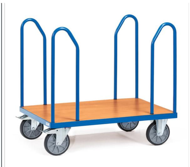
Ensemble mécano-soudé, revêtement époxy bleu RAL 5007, plateau en mélaminé surface effet hêtre avec arceaux latéraux en tube, hauteur 750 mm. 2 roues pivotantes et 2 roues fixes à bandage TPE, moyeu à roulement à billes central. Freins sur roues pivotantes conformément à la Norme 1757-3 (Sécurité des chariots de manutention).
