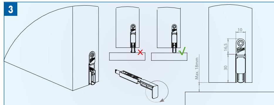
**NL** Stel de slag van de afdichting in door middel van de verstelbare aandrukknop (zie afbeelding). Teveel druk op de ondergrond en daarmee vervorming van de afdichting dient te worden voorkomen.
