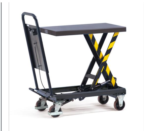
En acier soudé, revêtement époxy Gris Anthracite RAL 7016. Dossier de poussée fixe boulonné, pompe hydraulique à pédale. Vitesse de descente réglable. 2 roues fixes et 2 roues pivotantes à bandage caoutchouc dur, moyeu à roulement à billes. Roues pivotantes avec freins.
