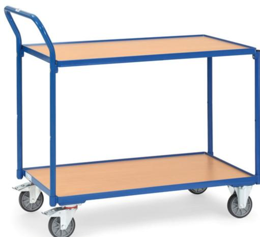
Ensemble mécano-soudé, revêtement époxy bleu RAL 5007 avec 2 plateaux en mélaminé surface effet hêtre, barre de poussée verticale, rebord de 12 mm. Charge maximum étagère haute : 80 kg. 2 roues pivotantes et 2 roues fixes à bandage TPE, moyeu à roulement à billes central. Freins sur roues pivotantes, conformément à la Norme EN 1757-3.
