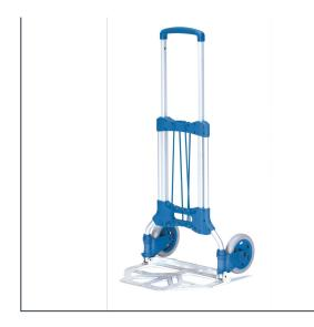
Fabrication de grande qualité en tube d'aluminium avec bavette en aluminium et parties en plastique de première qualité. Poignée de sécurité en plastique agréable au toucher. Sandow pour sécuriser les charges. Mise en place des roues et bavettes en quelques secondes. Roues à bandage polymère bleu gris "non traçant", moyeu à roulement à rouleaux.
