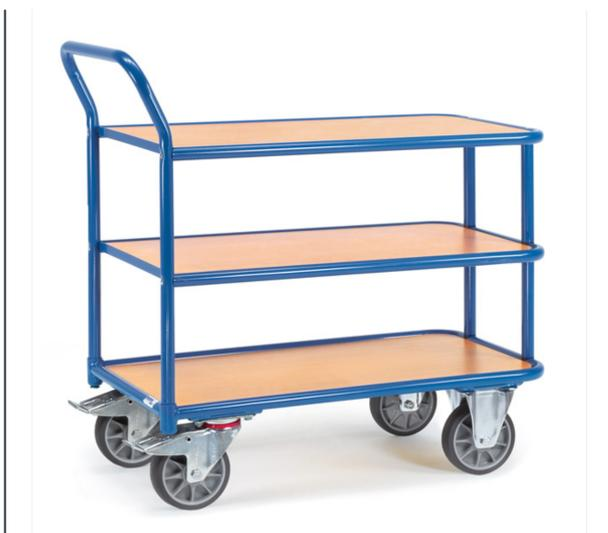
Ensemble mécano-soudé en tube d'acier, revêtement époxy bleu RAL 5007 uniquement. Plateforme en mélaminé surface effet hêtre. Plateaux du haut et milieu amovibles. 2 roues pivotantes et 2 roues fixes à bandage TPE, moyeu à roulement à billes central. Freins sur roues pivotantes conformément à la Norme EN 1757-3. Charge plateau du haut et milieu 120 kg.
