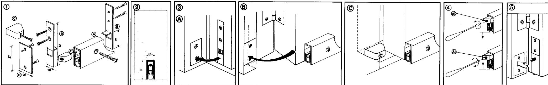
U treft in deze verpakking een automatische dorpelstrip aan, die hetzij op, of -met gebruikmaking van de bijgeleverde montageplaatjes - in de deur geplaatst kan worden. Bij montage in de deur moet een sleuf in de deur gefreesd worden. Voor de maten verwijzen wij naar de tekeningen. Elke standaardlengte kan tot maximaal 10 cm worden ingekort aan de kant tegenover de steelschroef. Het beweegbare deel dient 5 mm meer ingekort te worden. Afzaaglengte automaat: deurbreedte -4 mm.
